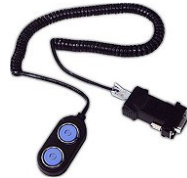
FIG. 5.3 – Capteur iButton DS1920 avec adaptateur DS9097U
