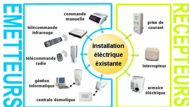
FIG. 1.2 – Un système X.10
